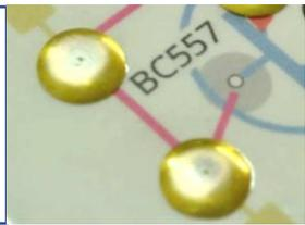
4. Lötkolben in Betrieb nehmen, aufheizen, 350°C, und dann wenigstens die Mitte der Reißnägel verzinnen
