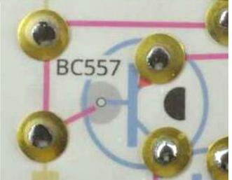
5. jeweils ein Stück Schaltdraht von der Isolierung befreien, „pinke“ Drahtbrücken erstellen; dabei möglichst **lange Verbindungen** in einem Stück erstellen
