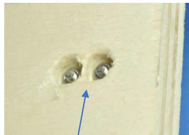
Bohrungen der Platine (3mm) sind **Referenz:**
